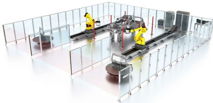
APDIS激光雷达DR600智能品质工作站可容纳完整的BiW底盘，可在车间进行快速、灵活的全自动测量。
