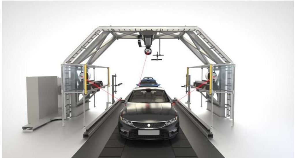
APDIS激光雷达间隙和面差系统采用三个APDIS激光雷达来覆盖大体积，并在移动线上检查间隙和面差；系统的对立支撑架增强了操作人员和产品的安全性。
