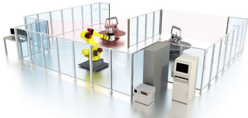
APDIS激光雷达R180智能品质工作站旨在检测车门等较小的部件，可安装在车间。
