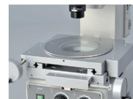
内置 50 × 50 mm 载物台和旋转台，可缩短测量时间。
