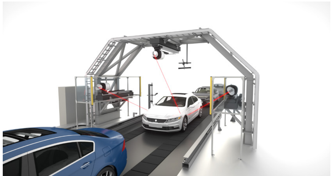
Gap & Flush 시스템에서 APDIS 이동은 컨베이어 이동과 동기화되며 필요한 수정은 정상적인 생산 속도를 늦추지 않고 안전하고 쉽게 오프라인으로 수행될 수 있습니다.
