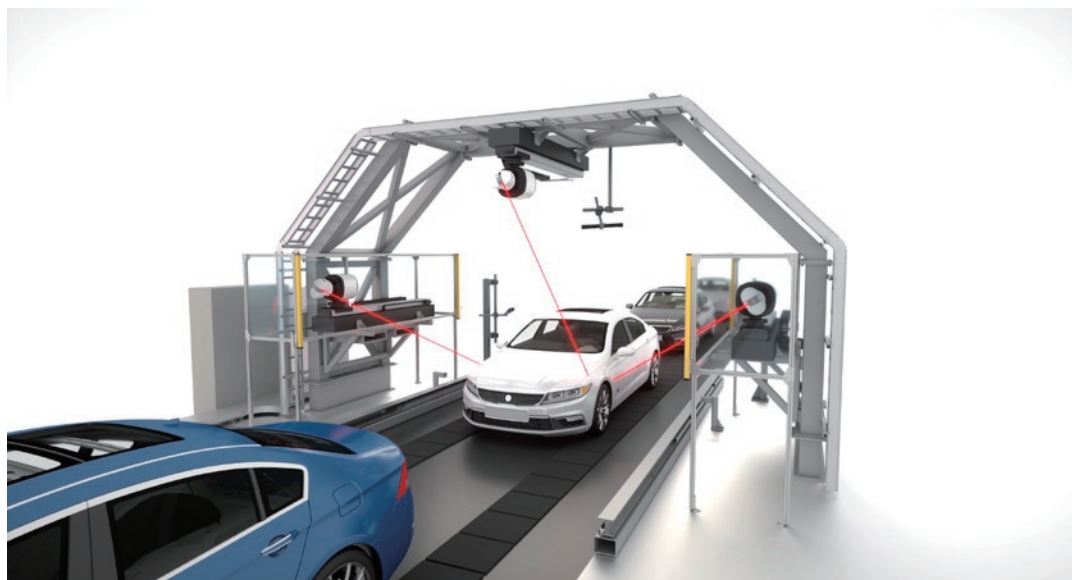
ギャップ&フラッシュシステムでは、APDISの動きとコンベアの動きを同期させることで、通常の生産速度を落とすことなく、安全かつ簡単にオフラインで必要な修正を行うことができます。
