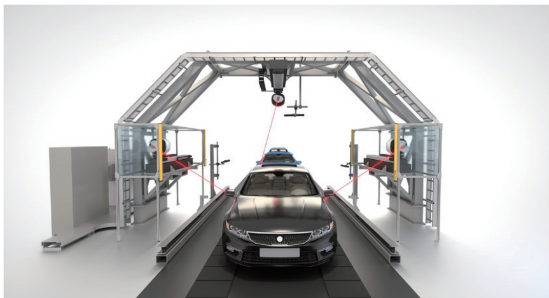
APDISレーザーレーダ ギャップ&フラッシュシステムは、3台のAPDISレーザーレーダで広範囲をカバーし、移動するライン上でギャップとフラッシュを検査するシステムです。このシステムは大きなスタンドオフを確保できるので、オペレーターおよび製品の安全性が向上します。
