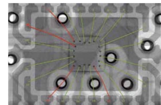
Analyse des fils de câblage
