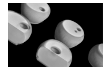
Vides dans les BGAs (Image par Tomographie Numérique)
