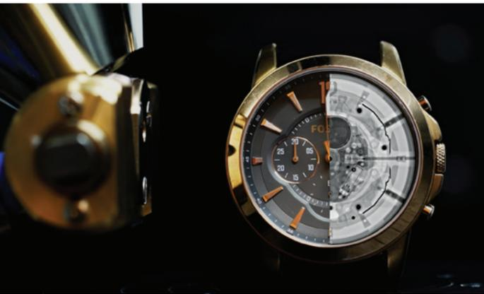
La tomographie à rayons X (CT) est utilisée depuis de nombreuses années dans les laboratoires pour inspecter de manière non destructive l'intérieur d'échantillons tels que des fossiles et des artefacts anciens. L'intérêt pour la recherche et le développement académiques s'explique par des raisons convaincantes : la tomographie permet une détection non destructive des vides, des fissures, des bavures et des autres imperfections à l'intérieur des pièces et des assemblages.
