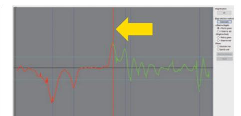
Sélectionner l'arête cible à partir d'un profil.
