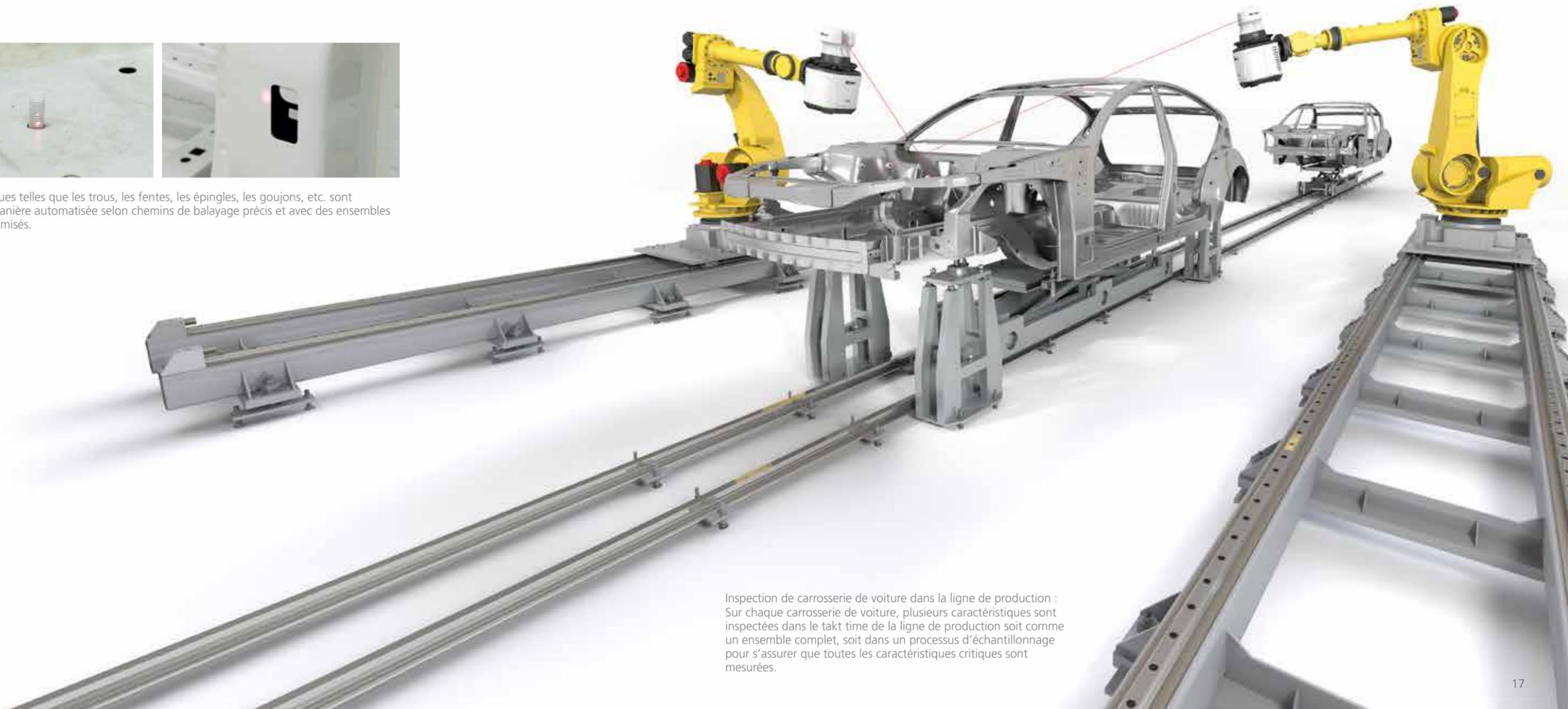
Inspection de carrosserie de voiture dans la ligne de production : Sur chaque carrosserie de voiture, plusieurs caractéristiques sont inspectées dans le takt time de la ligne de production soit comme un ensemble complet, soit dans un processus d'échantillonnage pour s'assurer que toutes les caractéristiques critiques sont mesurées.
