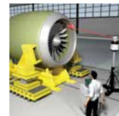
Le radar laser APDIS est utilisé pour l'inspection de grands volumes d'objets allant d'une porte de voiture à un avion entier, ce qui permet de réduire les coûts et d'améliorer la qualité des produits et des processus.
