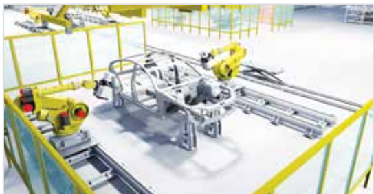
Inspection de déviation : En retirant automatiquement une carrosserie de voiture de la ligne, une inspection détaillée est possible sur beaucoup plus de composants qu'auparavant. Après inspection, la caisse est automatiquement réinsérée dans la ligne de production pour une intégration parfaite.
