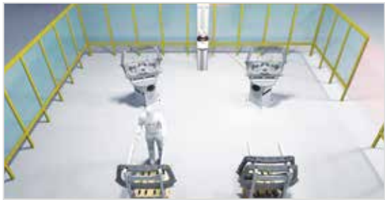
Inspection des composants : L'inspection des pièces entrantes est essentielle pour éviter les problèmes d'assemblage plus loin dans la chaîne de production. Le radar laser APDIS permet une inspection rapide et sans contact des caractéristiques et de la surface des composants, des portes aux ailes, pour obtenir un rapport instantané de qualité des composants de fournisseurs externes.
