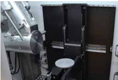
La source haute brillance 450 kV offre les mêmes avantages qu'une cible rotative : collecte de données plus rapide ou une qualité de données supérieure à puissance continue.
