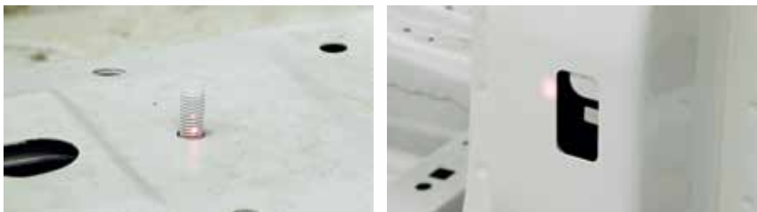
Les caractéristiques telles que les trous, les fentes, les épingles, les goujons, etc. sont inspectées de manière automatisée selon chemins de balayage précis et avec des ensembles de données optimisés.
