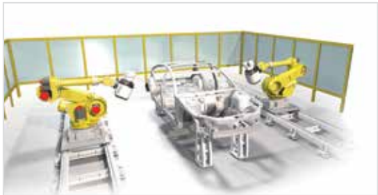
Salle de métrologie : En utilisant l'APDIS dans la salle de métrologie pour remplacer les MMT traditionnelles, les opérations hors-ligne cessent d'être un goulot d'étranglement grâce aux mesures plus rapides permettant une investigation précoce des problèmes.
