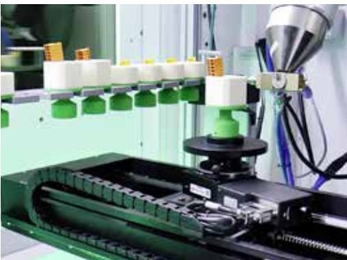
L'inspection semi-automatisée permet l'automatisation de toutes les tâches avec le chargement de pièces multiples.
