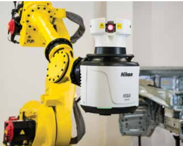
Le radar laser APDIS monté sur un robot est une alternative innovante pour un bras horizontal traditionnel de MMT
