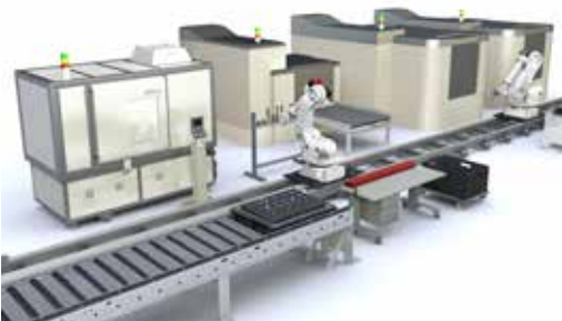
L'automation intégrée permet la pleine intégration de l'inspection TDM dans votre chaîne de production.
