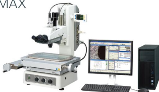
Apporte à l'utilisateur différentes mesures avancées et des fonctions de traitement. La détection automatique des bords avec un traitement inférieur au pixel permet de réaliser des mesures plus répétitives et plus précises.
