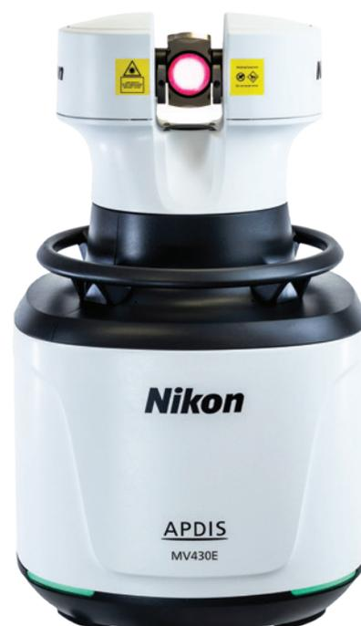
Das APDIS Laser Radar ermöglicht eine schnelle, automatisierte und kontaktlose Inspektion. Das APDIS ist tragbar und erfordert nur minimale Einrichtungszeit.
