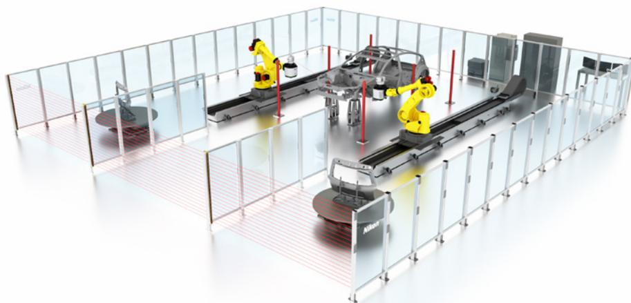
Die APDIS Laser Radar DR600 IntelligentQuality Station kann komplette BiW-Chassis mit schnellen, flexiblen und vollautomatischen Messungen direkt in der Fertigungshalle aufnehmen.
