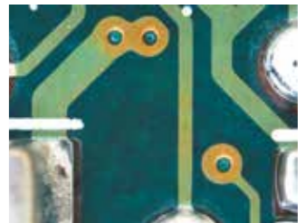
Gedruckte Leiterplatte (Hellfeld)
