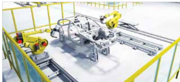
Bypass-Inspektion: Durch die automatische Entnahme einer Karosserie aus der Linie ist eine detaillierte Inspektion von wesentlich mehr Komponenten möglich als bisher. Nach der Inspektion wird die Karosserie automatisch wieder in die Produktionslinie zurückgeführt, um eine nahtlose Integration zu gewährleisten.
