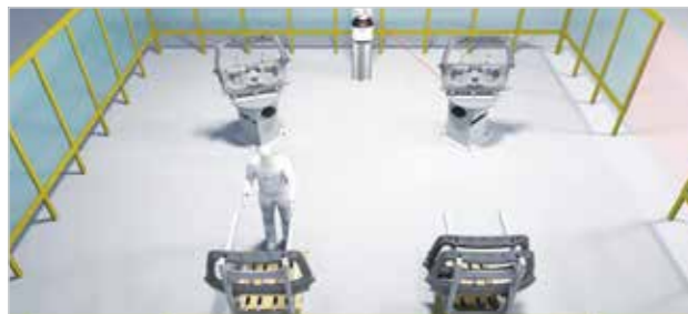
Komponenteninspektion: Die Eingangsprüfung von Teilen ist entscheidend, um Montageprobleme im weiteren Verlauf der Produktionslinie zu vermeiden. Das APDIS Laser Radar ermöglicht eine schnelle, berührungslose Merkmals- und Oberflächeninspektion an Bauteilen, von Türen bis hin zu Karosserieteilen, um einen sofortigen Qualitätsbericht über Komponenten von externen Zulieferern zu erhalten.
