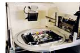
Der relevante Messbereich bleibt bei jeder Kombination von Drehung, Schwenkwinkel und Vergrößerungsstufe durchgehend im Mittelpunkt des Sichtfeldes
