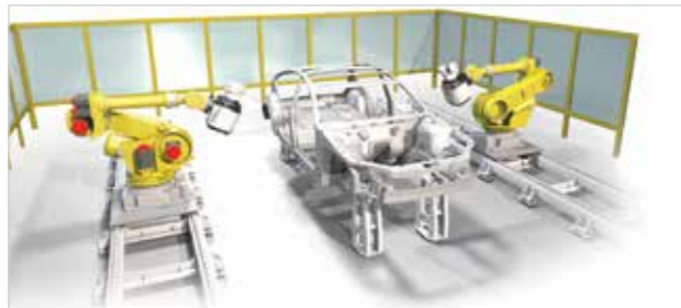
Messraum: Durch den Einsatz von APDIS im Messraum als Ersatz für herkömmliche KMGs stellt die Offline-Anlage keinen Engpass mehr dar, da schnellere Messungen eine schnellere Untersuchung der Probleme ermöglichen.
