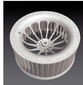
CT-Scan eines Kunststoffventilators
