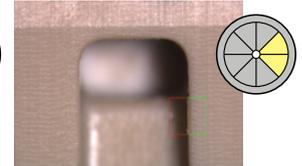
Jedes Segment der 8-segmentigen Ringbeleuchtung kann für die Kantenerkennung angewählt werden.
