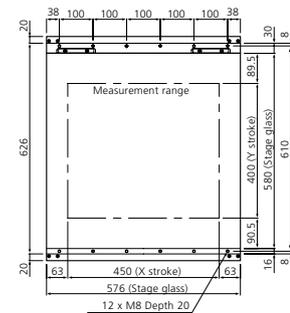
Geeignet für Objekte mittlerer Größe (250 x 200 x 200 mm – 450 x 400 x 200 mm) und die Messung von mehreren Kleinteilen gleichzeitig. Sehr gutes Preis-Leistungs-Verhältnis, da dieses Modell in derselben robusten Gusseisenkonstruktion und Direktlagerung ausgeführt ist wie das Premiummodell der NEXIV VMZ-R Serie.
