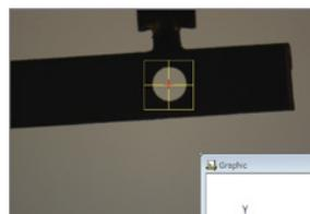
Ein falsch ausgerichtetes Muster wird automatisch mithilfe der intelligenten Suchfunktion erkannt
